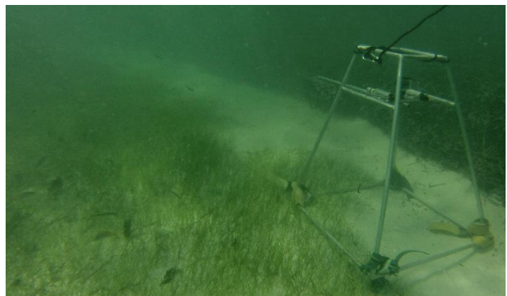
Figure 9a et 9b : Structures de soutien pour les caméras (BRUV et photogrammétrie laser). ©Nicolas Boudin
