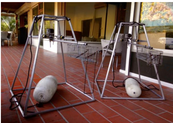
Figure 9a et 9b : Structures de soutien pour les caméras (BRUV et photogrammétrie laser). ©Nicolas Boudin
